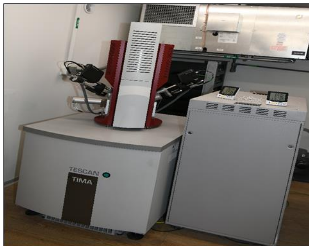
Imagen 01. SEM-TIMA instalado en Metalurgia – Concentradora – Antamina. Fuente: Elaboración propia.
